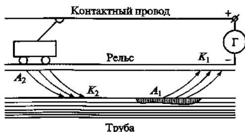
Рис. 10.10. Схема коррозии трубопровода блуждающими токами
