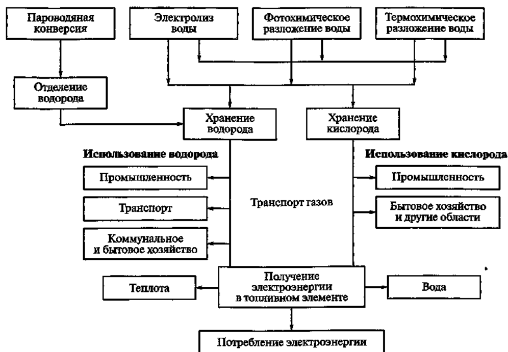
Рис. 15.6. Водородная энергетическая система
