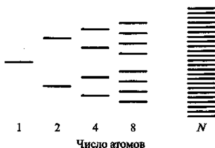
Рис. 4.10. Изменение энергии молекулярных орбиталей при увеличении числа реагирующих атомов
