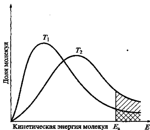
Рис. 7.4. Распределение молекул по энергиям при двух температурах ( T_2 > T_1 )
