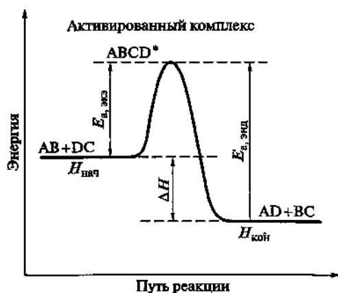
Рис. 7.3. Энергетическая диаграмма хода реакции с образованием активированного комплекса
